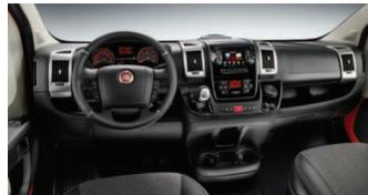
El volante se sujeta con facilidad, tiene la inclinación normal de un automóvil y puede ajustarse axialmente a lo largo de 50 mm. El panel incluye portabotellas y compartimentos para objetos, abiertos o cerrados, portavasos integrado y espacio para smartphone o lectores mp3.
