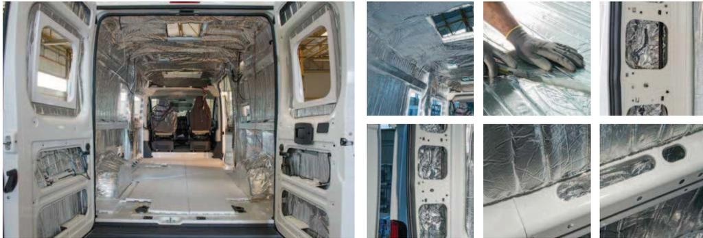
**TEST EN CÁMARA CLIMÁTICA** según la normativa EN 1646-1, por la que un vehículo puesto a -15° debe alcanzar + 20° en 4 horas, ha demostrado que el aislamiento WPS: Reduce al 50% el tiempo para alcanzar temperaturas agradables en el interior del vehículo también partiendo de situaciones de extremado frío. Aumento de más del 65% la uniformidad de la temperatura interna de las diversas zonas de la van.
